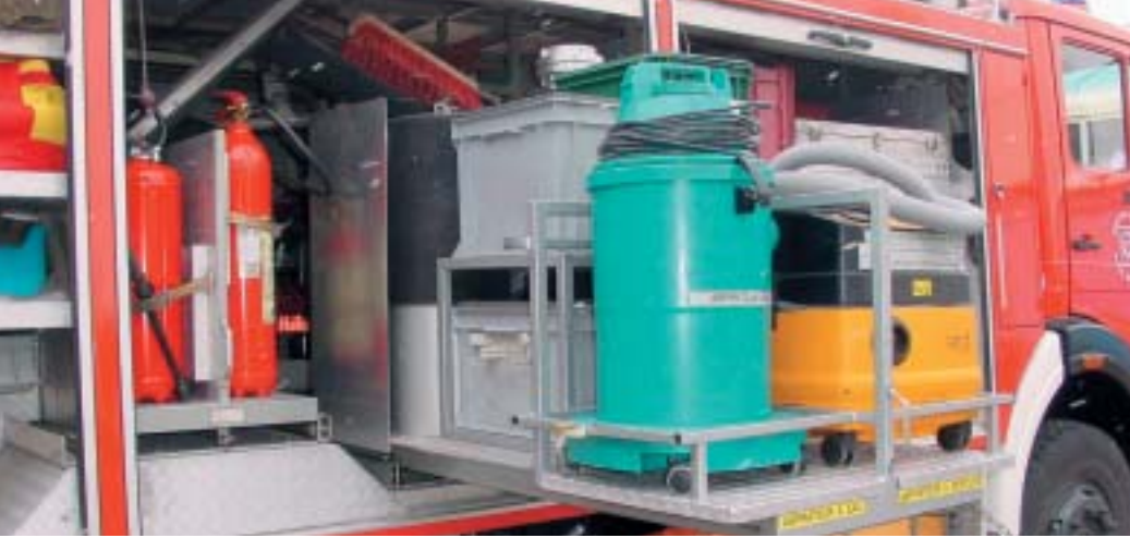
Rüstwagen auf MB 1019 (Ausbau Ziegler/Vogt) von 1983: Das Fahrzeug ist unter anderem mit verschiedenen Industriestaubsaugern zum Aufnehmen von festen und flüssigen Verunreinigungen beladen (Bild oben). Darüber hinaus gehören ein Stromerzeuger (6,5 kVA), Dichtkissen sowie neun Pressluftatmer mit je zwei Atemluftflaschen zur Ausrüstung.
