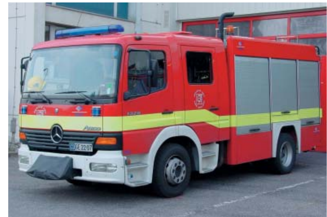
Unten: Hilfeleistungslöschfahrzeug (HLF) auf Atego 1328, gebaut 2002 von der italienischen Firma BAI. Das Fahrzeug ist ausgerüstet unter anderem mit einem 2000-Liter-Löschwassertank sowie einer Godiva-Pumpe (WTA 2000) mit einer Leistung von 2200/200 l/min. bei 10/40 bar.
